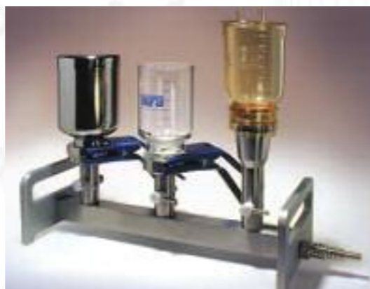
Rampa de filtração
